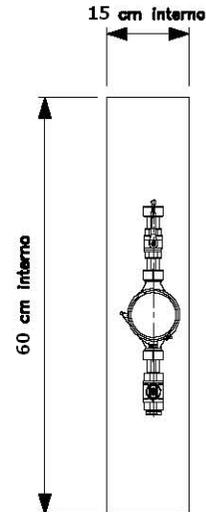
PER UN NUMERO DI CONTATORI SUPERIORE A 4, LA LARGHEZZA DEL POZZETTO VERRA' AUMENTATA DELLA MISURA DEL MODULO PROPORZIONALMENTE AL NUMERO DI CONTATORI RICHIESTI.
